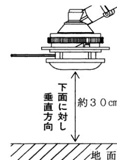
コンクリートなど硬い場所に落下させない事。かえって出にくくなるうえに早期破損の原因となる。
