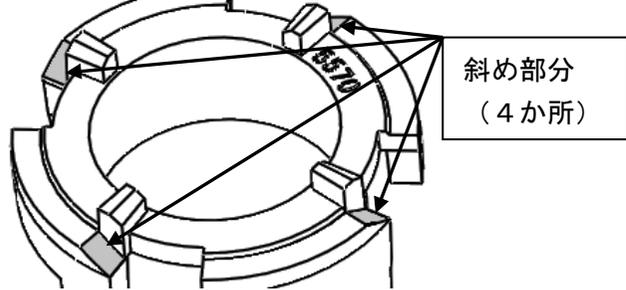
4. リール B は、スライダを本体に指で押し当てスプリングが縮んだ状態にしながら取付ける。リール B に凹形状、リール A に凸形状があるので角度を合わせる事
