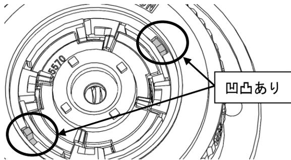
5. キャップは、リール B を指で下に押さえながら組付ける。その際、キャップの凹形状とボディの凸形状を合わせたうえで組付ける。組付け後にロックアームをかける
