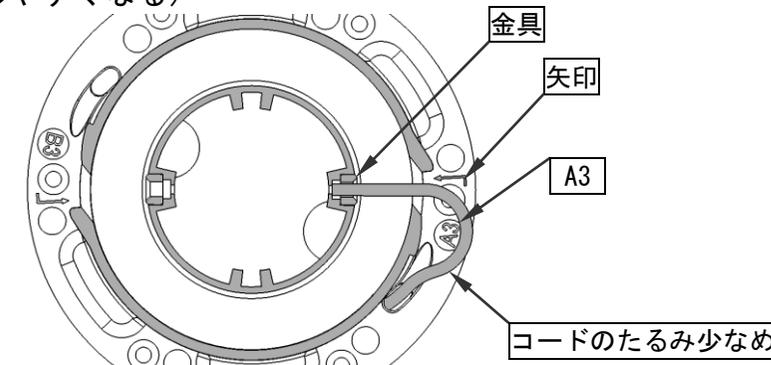
**注意** コードの先端が変形していると差し込めないことがある
