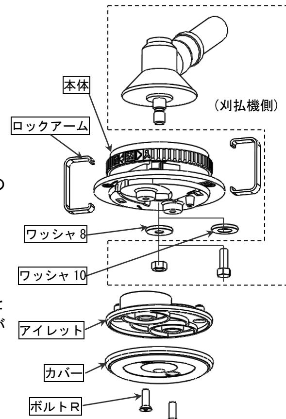
**注意 1** 本体が樹脂なので、強すぎる力で締めると本体に亀裂が入り、草刈り作業中に本体が吹っ飛び怪我をする恐れがある
