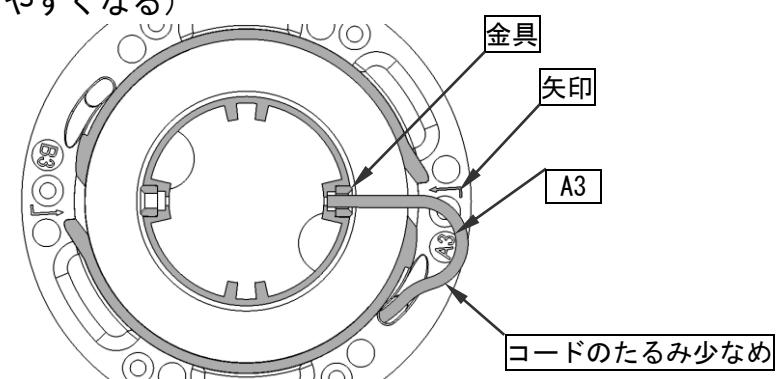
**注意** コードの先端が変形していると差し込めないことがある
